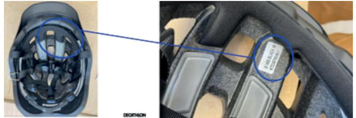
El motivo de la retirada es que a pesar de llevar a cabo rigurosos controles de calidad, se ha detectado que una pieza de plástico situada en la parte posterior del casco y que sujeta la correa de la barbilla puede romperse. Si esto llegase a suceder, el casco no se mantendría en su sitio en caso de impacto durante una caída.
